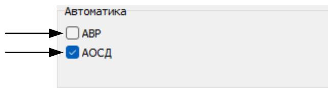
Рисунок 8.2.2.6 – Видеокадр «Схема и режим». Панель «Автоматика»: 1 – метка включения/выключения автоматики ввода резерва (АВР) от внешней сети; 2 – метка включения/выключения автоматики опережающего сбалансированного деления (АОСД)
