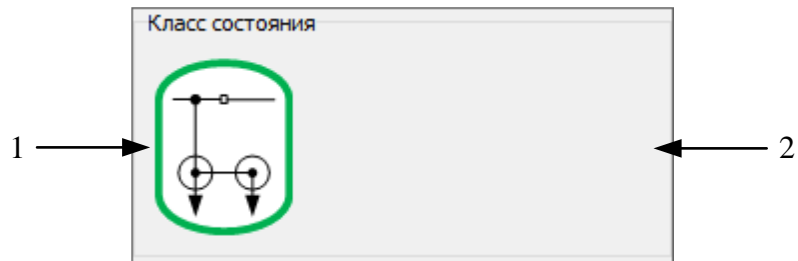
Рисунок 8.2.2.2 – Видеокадр «Схема и режим». Панель «Класс состояния»: 1 – пиктограмма текущего класса состояния; 2 – поле вывода описания текущего класса состояния
