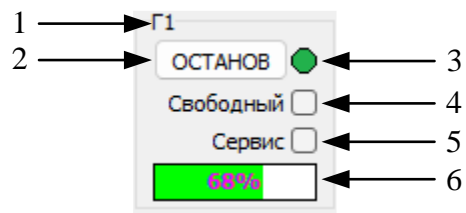
Рисунок 8.2.2.12 – Видеокادر «Схема и режим». Панель «Генератор»: 1 – наименование генератора; 2 – кнопка пуска/останова энергоблока; 3 – индикатор эксплуатационных состояний генератора; 4 – метка перевода генератора в режима свободного; 5 – метка перевода генератора в сервис; 6 – индикатор загрузки генератора по активной мощности в процентах от номинального значения
