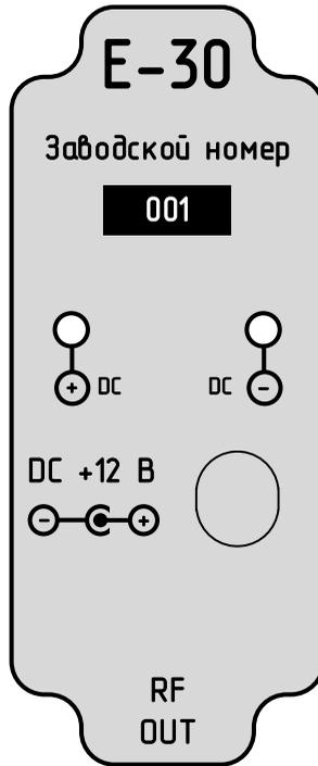
Рис. 1 – Маркировочная табличка (пример)
