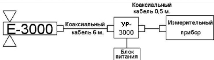
Рис. 2 – Схема включения Антенны
