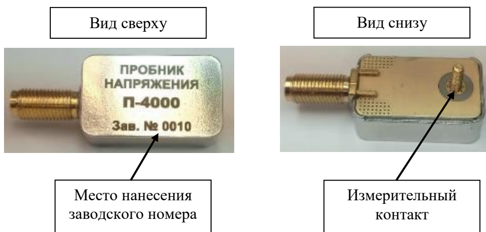
Рисунок 1 – Общий вид пробников с указанием мест расположения измерительного контакта и нанесения заводского номера
