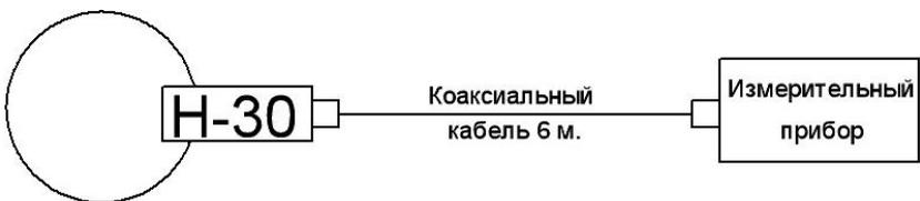
Рис. 1 – Схема включения Антенны в пассивном режиме
