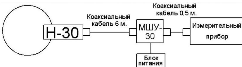
Рис. 2 – Схема включения Антенны в активном режиме
