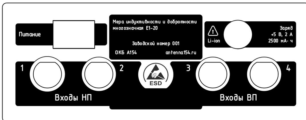
Рис. 2.4 – Задняя панель
