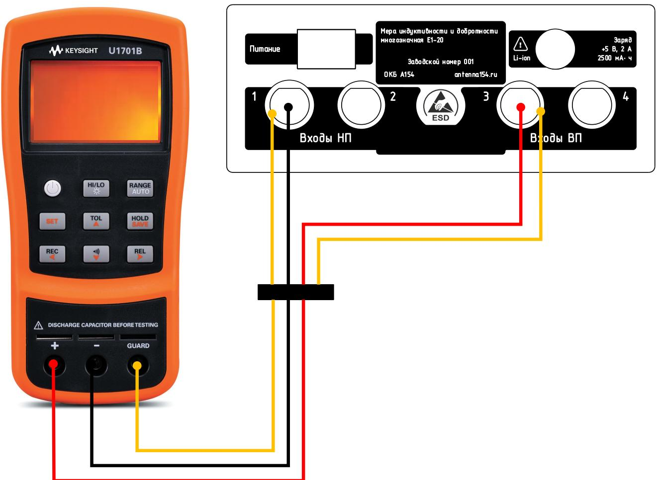
Рис. 3.2 – Схема двухпроводного подключения Меры к измерителю иммитанса
