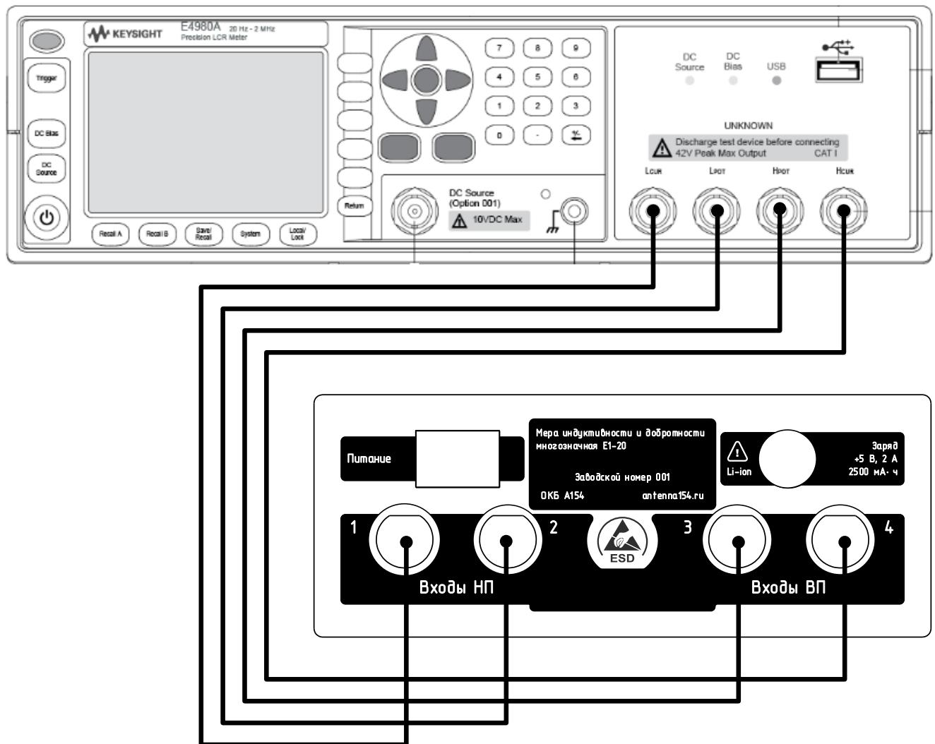
Рис. 3.1 – Схема четырёхпроводного подключения Меры к измерителю иммитанса
