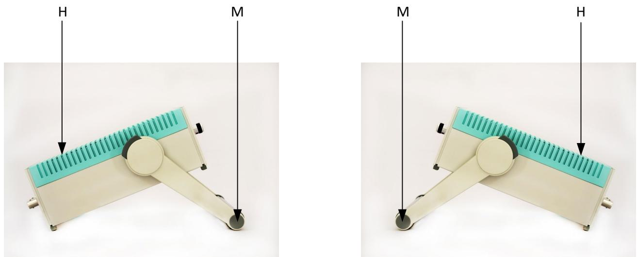
Рис. 2.5 – Места постановки пломб: М – мастичная пломба под крышкой рукоятки,
